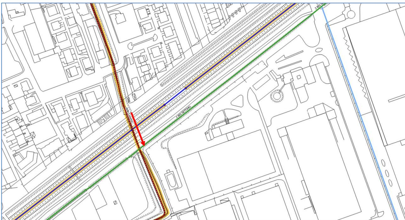
Figura 4. Ricostituita la continuità idraulica del CSNO (tratto blu) ed eliminati i rispettivi nodi di fine e ripresa. Eliminato il nodo di confluenza posto poco a valle della discontinuità, in quanto il canale secondario (Fontanille delle Casette) supera il CSNO.
