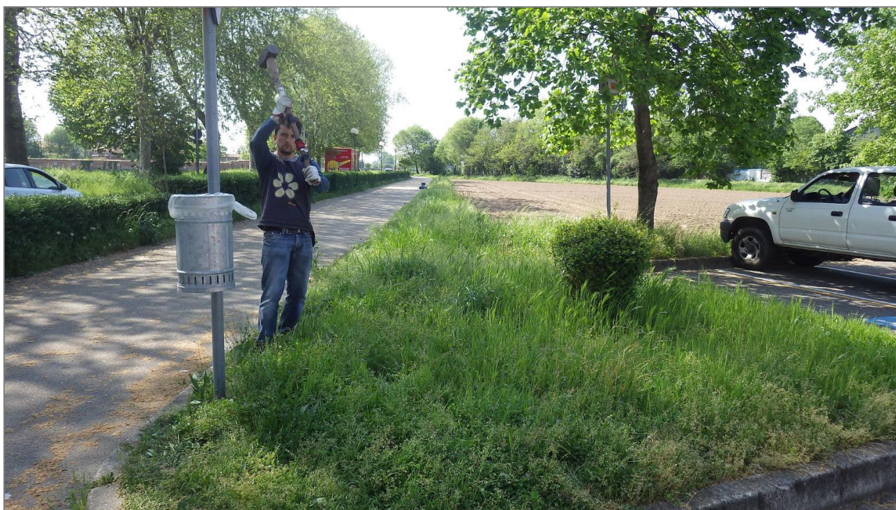
Fig. 34. Esecuzione della prova ReMi/MASW sul sito d'indagine R4.
