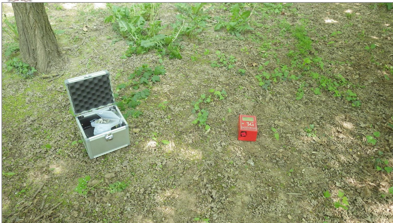
Fig. 33. Esecuzione della prova HVSR sul sito d'indagine R2.
