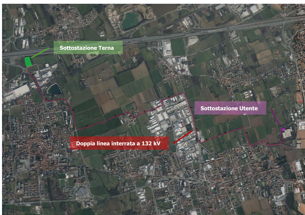
Percorso totale del cavidotto
