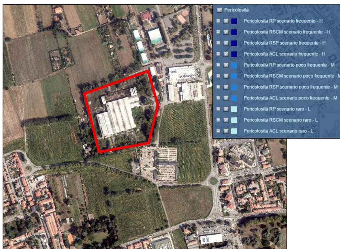
Figura 3 – Stralcio della “Mappa della Pericolosità Idraulica” tratta dal P.G.R.A. dell’Autorità di Bacino del Fiume Po.
