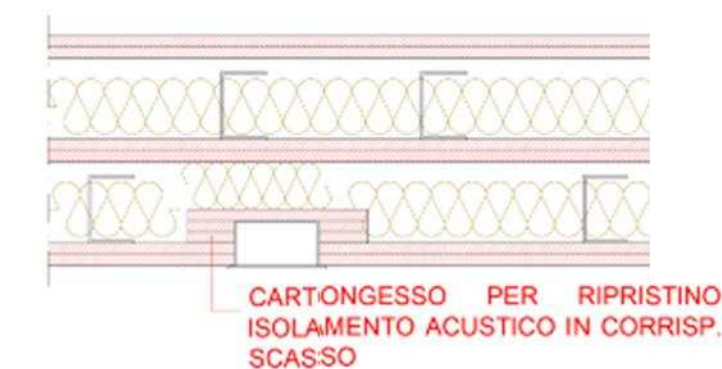
Ripristino isolamento acustico sul retro delle scatolette
